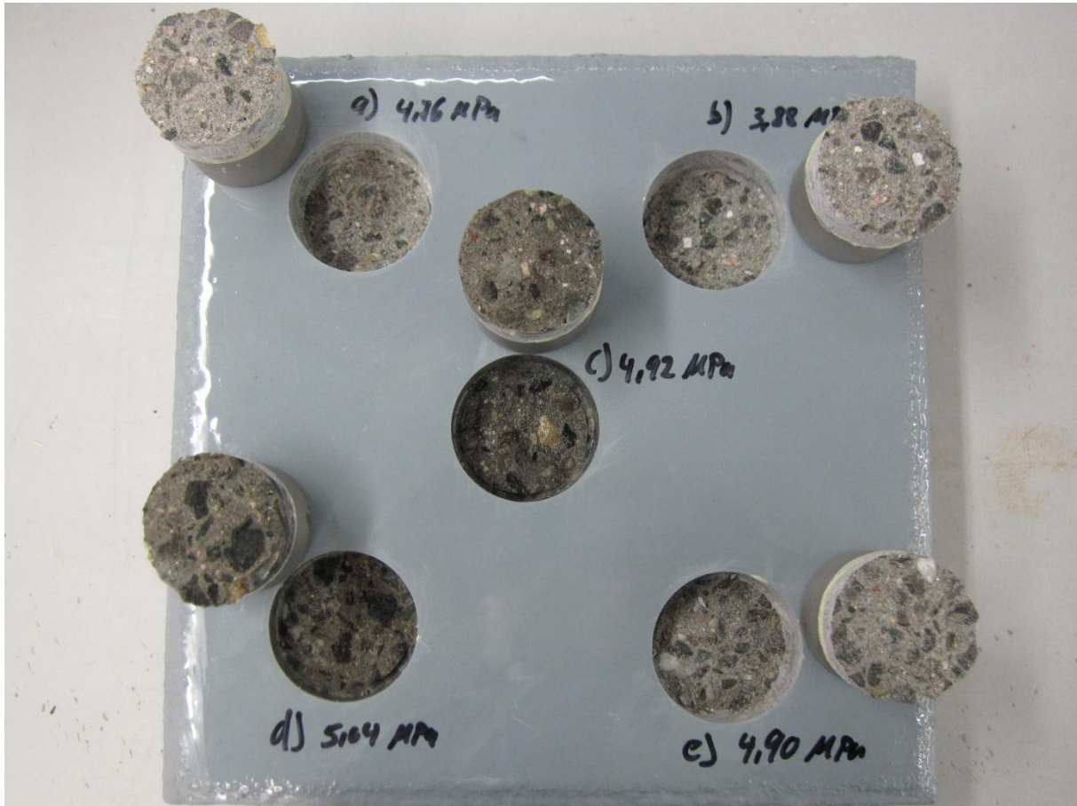
Abbildung 3: Bruchbilder Haftfestigkeit nach 240 Tagen Beanspruchung mit rückseitiger Feuchteinwirkung bei ca. 8 °C und ca. 80 % rel. Luftfeuchte
