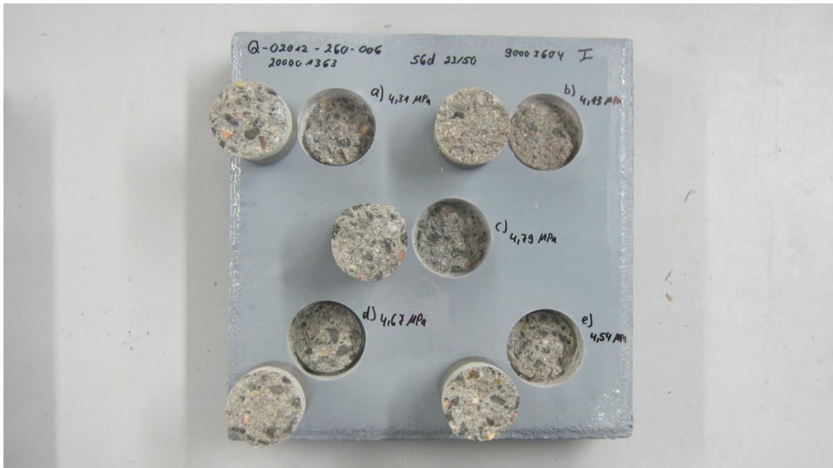
Abbildung 1: Bruchbilder Haftfestigkeit nach 56 Tagen Lagerung bei 23°C und 50 % rel. Luftfeuchte
