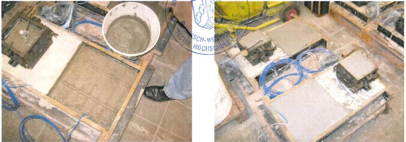
**Bild B7:** Reprofilierung der simulierten Reparaturstellen mit Disbocret 715 und Disbocret 713
